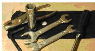
пока мне ни разу не понадобился (тьфу-тьфу, конечно!). Тем не менее в расчёте на будущие неприятности дополнил его набором для ремонта камер «Тип-Топ» и накидным ключом на 24 для демонтажа заднего колеса. Рожковую часть ключа отрезал и этот
