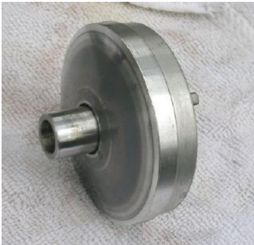
Поставим упорную пластину. Она находится с обратной стороны вариатора.
